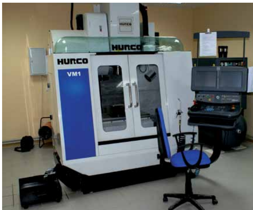
Рис.4. Вертикальный обрабатывающий центр HURCO VMX1 с ЧПУ (совместный проект МГУ имени М.В.Ломоносова и Академии биосенсоров)
